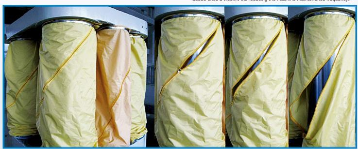
11. 采用全新复合材料"纳米尼龙"布料, 有防水、防尘、抗拉力防磨损等特点,使用可拆式拉链结构有利于方便更换。
