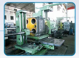
2. 采用数控镗床加工柱孔、主轴箱等,有效保证同心度 的加工精度,提高产品稳定性。
