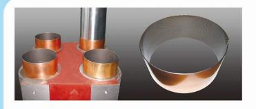
升降导柱与中座接触面采用表面轧制美国杜邦"聚四氟乙烯"聚合物材料的导套;导套表面轧制成圆形储油坑,在少油或间隙断油条件下能正常工作,具有摩擦系数低、耐磨性能好,使用寿命长等优点。
