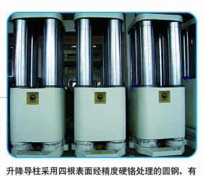
间隙小,整体刚性好,切割时晃动小,使用寿命长 等优点。
